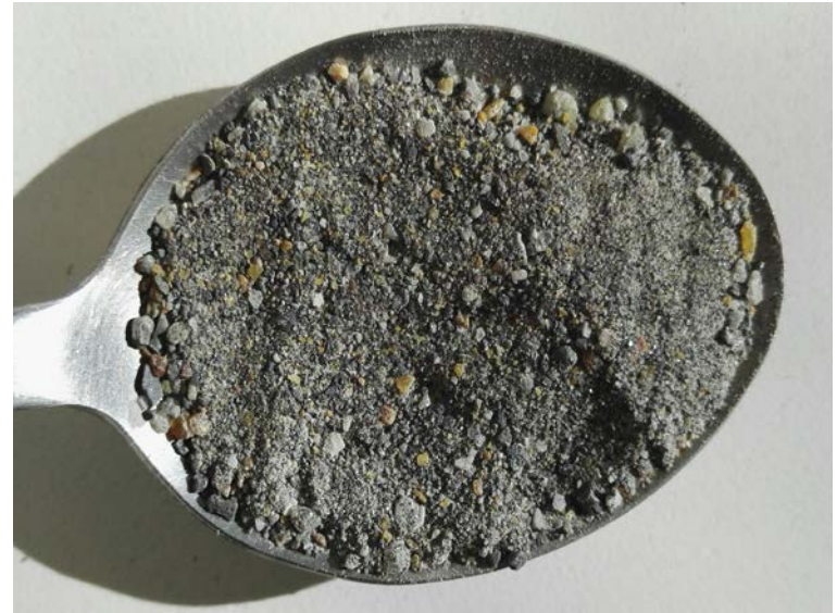
Leijukattilassa regeneroitu MgO-C, korkealuokkainen, fused MgO materiaali
