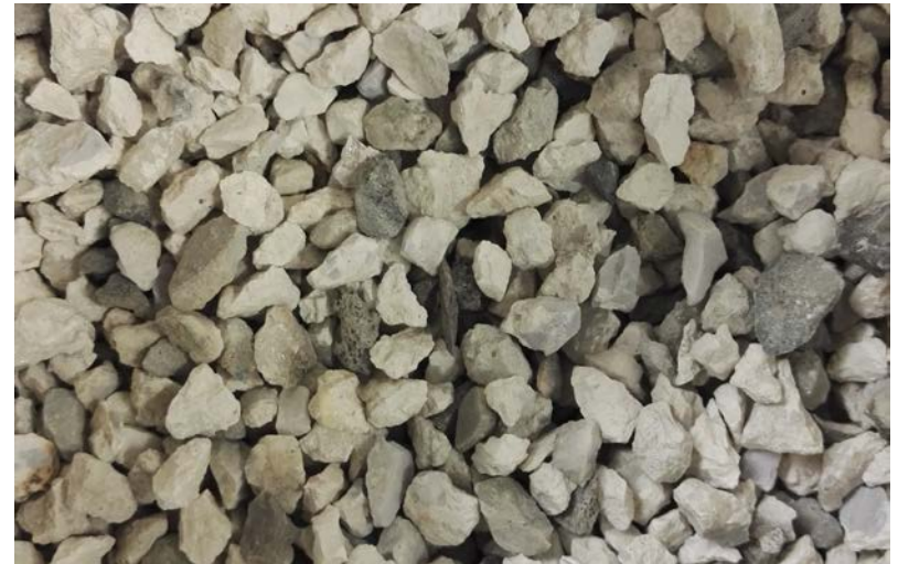
3-6 murskattua ja seulottua Al 2 O 3 -spinelli-Materiaalia terässenkan kulutusvuorauksesta
