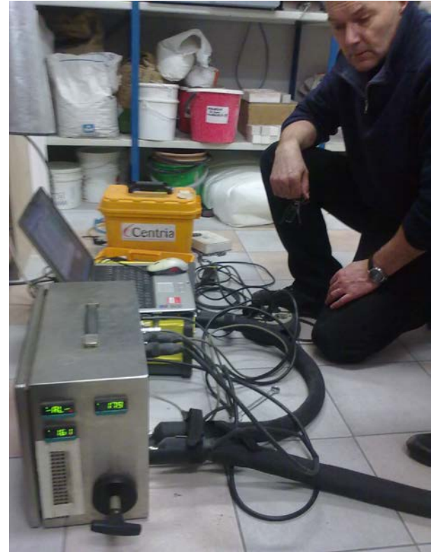
FT-IR kaasuanalyysi BK:n laboratorio, va. kuivamassassa syntyvät kaasut
